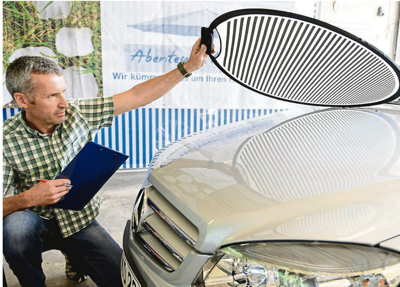
Wo verstecken sich die Hagel-Schäden? Mit einer speziellen Technik macht der Sachverständige Jens Bremer, der die Schäden für die Versicherungskammer Bayern begutachtet, die Dellen auf der Motorhaube sichtbar. FOTOS: THOMAS PLETTENBERG
